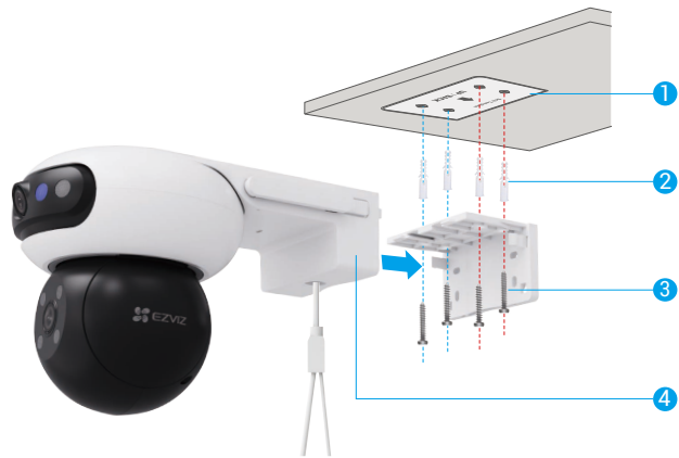
Εικ. 1 Τοποθέτηση στην οροφή
